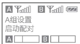
在发射器上使用 +/- 键选择“Match with RX (启动配对)”
