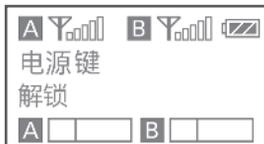
**电源键设置：**长按 SET 键设置锁定 / 解锁电源键。锁定电源键可开启防误触功能。
