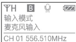
输入模式设置：长按 SET 键进入输入模式设置，可将产品输入孔设置为麦克风输入 / 线路输入模式。（默认为麦克风输入）
