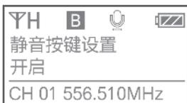
静音键设置：开启 / 禁止静音功能（开启为系统默认设定）
